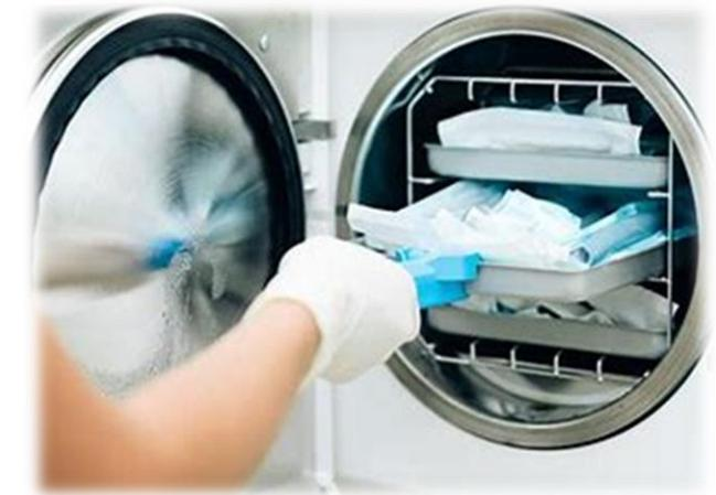
La presenza di contaminanti può portare alla formazione di depositi minerali (incrostazioni) sugli strumenti e sulle superfici interne dell'autoclave, riducendo l'efficacia della sterilizzazione e causando potenziali danni agli strumenti
